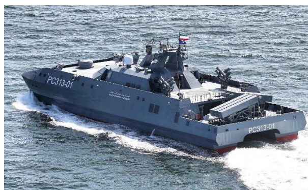
בתמונה: הספינה הראשונה מדגם שהיד אבו מהדי אל מוהנדס (PC313-01). בתמונה זו ניתן לראות את פריסת משגרי הטילים על הספינה.
