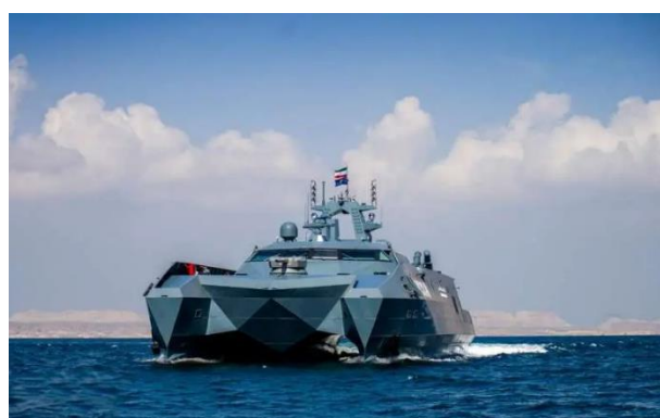
בתמונה: הספינה הראשונה מדגם שהיד אבו מהדי אל מוהנדס (PC313-01). בתמונה זו ניתן לראות את פריסת משגרי הטילים על הספינה.
