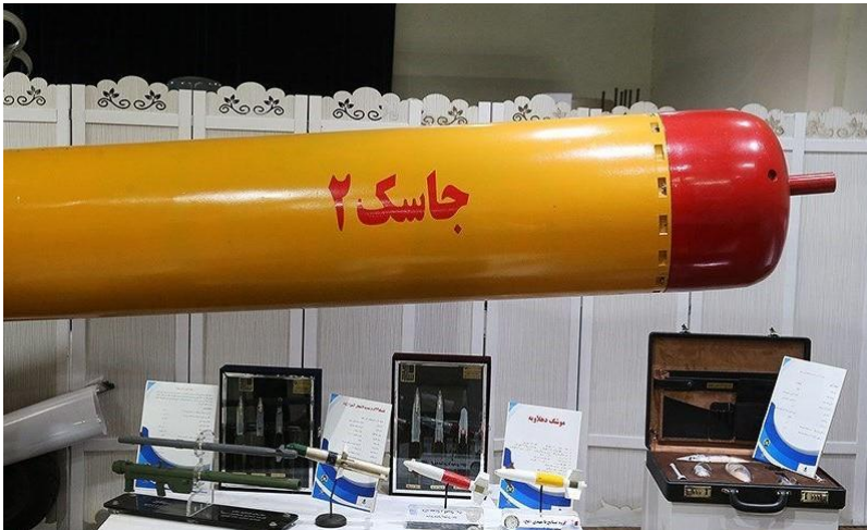
בתמונה: הקפסולה באמצעותה משוגר הג'אסק מצוללות
